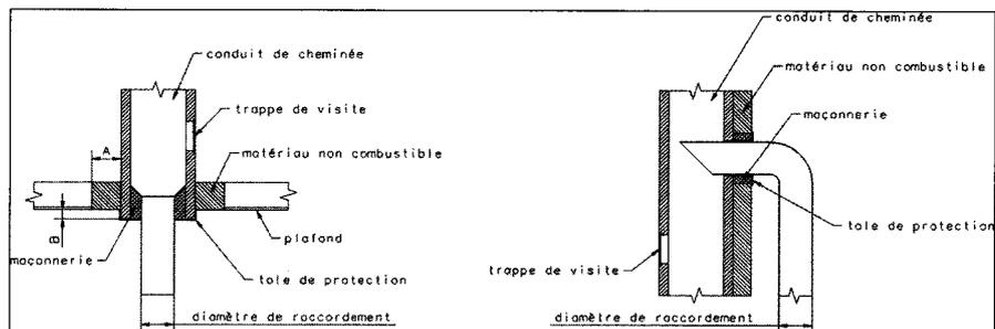
Exemple d'un raccordement au conduit de cheminée
