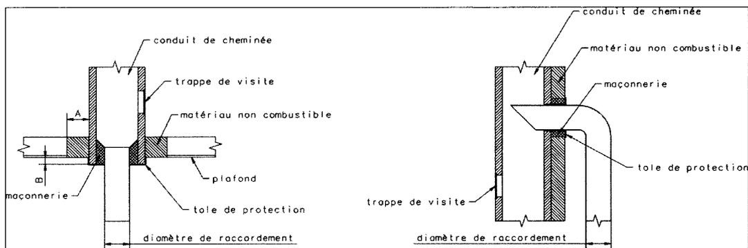
Exemple d'un raccordement au conduit de cheminée
