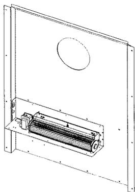
Le kit turbo permet d'accélérer la convection naturelle de l'appareil permettant ainsi d'augmenter le rendement thermique et d'obtenir une meilleure répartition de l'air chauffé dans la pièce.
