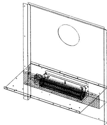
1. Fixer le support ventilateur sur la pièce « derrière » à l'aide de 6 vis.
